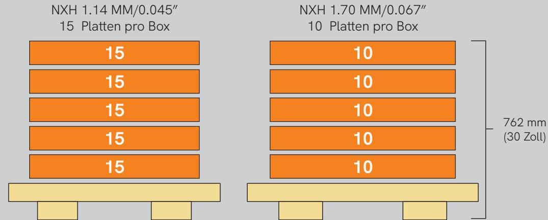
Volle Paletten mit 5080- und 5065-Plattenkartons enthalten 5 Kartons für unterschiedliche FLEXCEL NXH-Plattenmengen. Diese Paletten können doppelt gestapelt werden.
